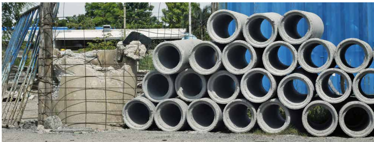
Canalisations en ciment contenant de l'amiante
